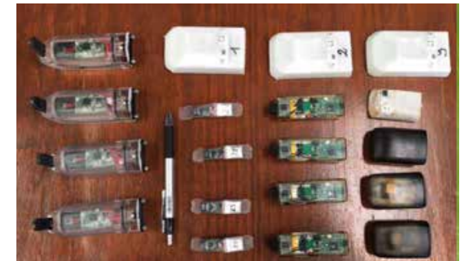
Diferentes tipos y tamaños de registradores electrónicos de movimiento y comportamiento animal. Los instrumentos poseen diferentes tipos de sensores que registran posición, aceleración, velocidad, profundidad, campo magnético, luz y temperatura. Los registros de estas variables pueden obtenerse a más de 30 datos por segundo. Foto: Flavio Quintana.
