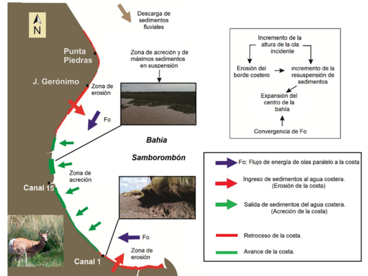
Modelo conceptual de los procesos básicos que ocurren en la bahía Samborombón. Los modelos numéricos indican un aumento de la altura de ola incidente sobre la costa de la bahía. Dicho incremento produce un aumento de la erosión de la escarpa costera, y favorece la re-suspensión de los sedimentos del fondo. Los sedimentos erosionados se acumulan en el centro de la bahía, donde se produciría la convergencia del flujo de energía de olas paralelo a la costa.
