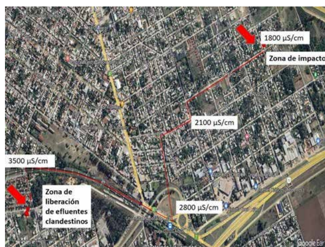
Figura 4. Valores de conductividad medidos en un arroyo canalizado. Los valores son más altos cerca de la fuente emisora del contaminante (una industria no autorizada que vertía a través de ductos pluviales marcados mediante la línea roja). Las flechas rojas indican la ubicación de la fuente emisora (3500 µS/cm de conductividad) y del cuerpo receptor (1800 µS/cm de conductividad). La distancia recorrida entre la fuente emisora y la descarga al cuerpo de agua fue de 3 km. Fuente: Adonis Giorgi.
